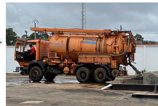
Dépotage de boues à la STBV d'Etoa
